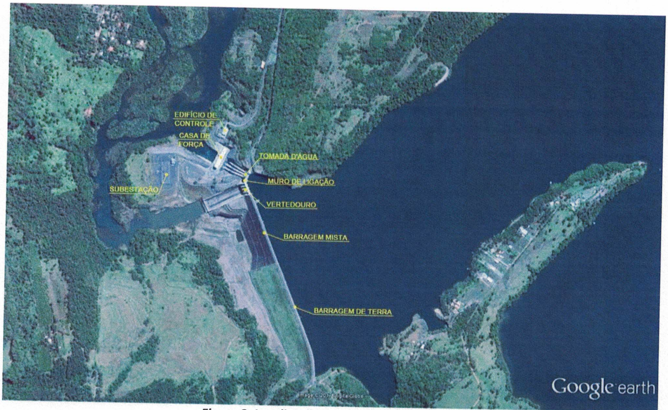
Figura 3: Localização das Estruturas da UHMI.
